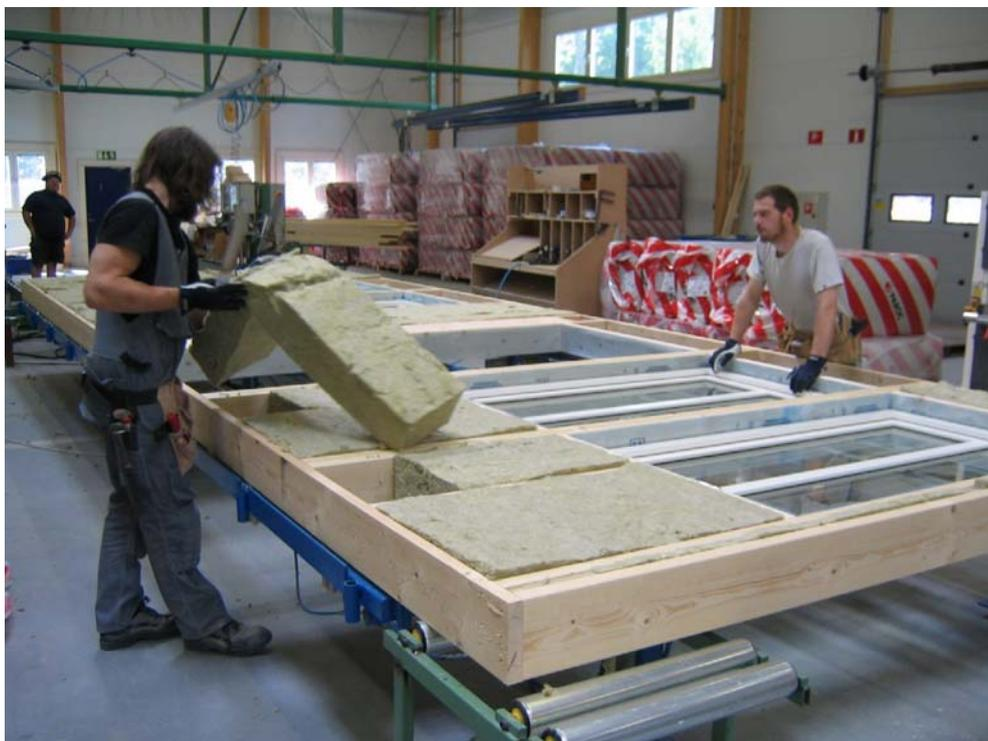
分厚い断熱材を外壁ブロックへ充填（スウェーデンの住宅工場）
